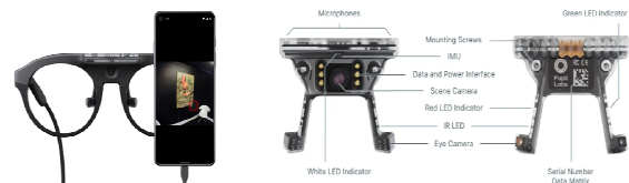
[그림 3] Pupil-labs사의 시선추적장치(glasses eye tracking device) 'NEON'
